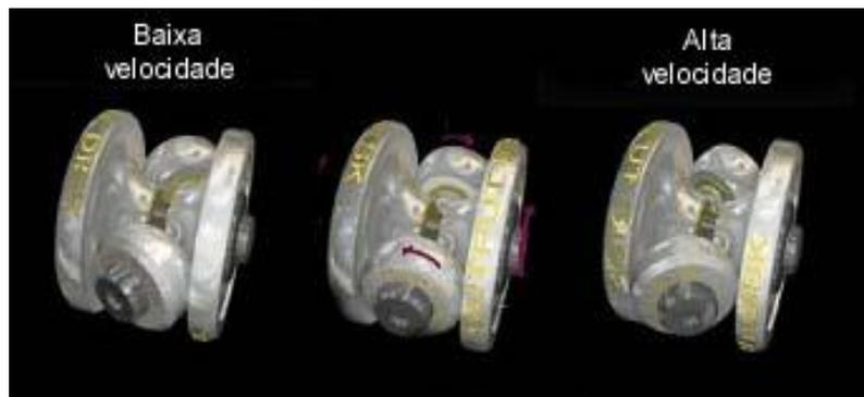
Figura 3 - Esquema de funcionamento da Toroidal CVT.
