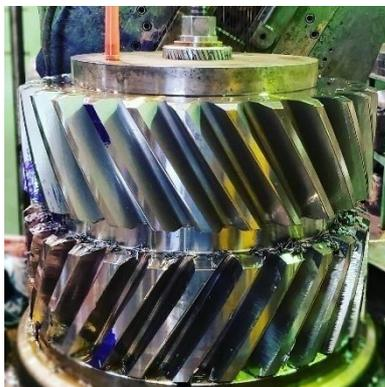
Figura 17 - Engrenagens cilíndricas de dentes helicoidais duplos.
