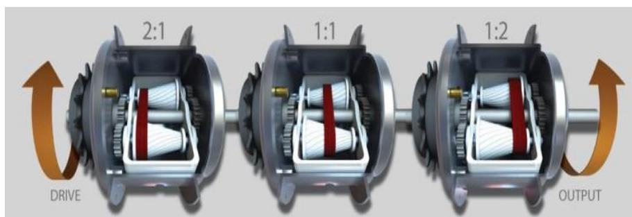
Figura 4 - CVT Cone ou de Fricção.
